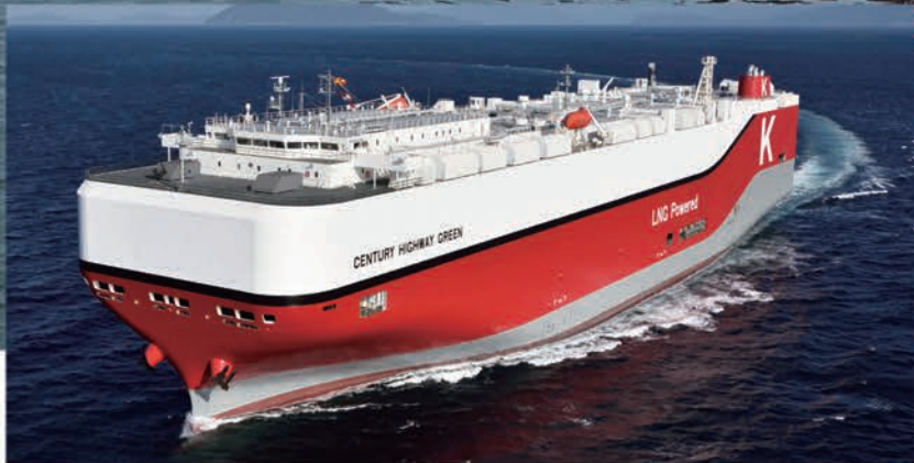
LNG 燃料自動車運搬船 「CENTURY HIGHWAY GREEN」 全長:199.98m 総トン数:73,515トン 写真提供:川崎汽船株式会社
