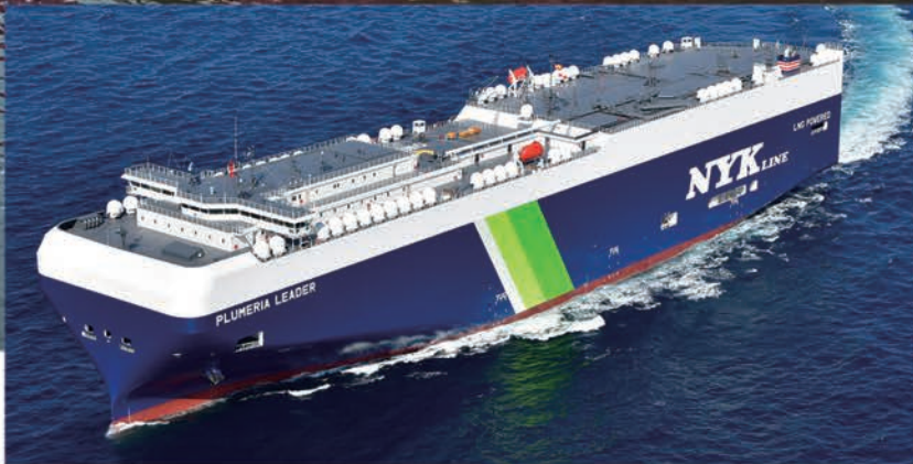
LNG 燃料自動車運搬船 「PLUMERIA LEADER」 全長:199.96m 総トン数:72,287トン 写真提供:日本郵船株式会社
